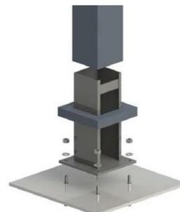
Fixation au sol par pied de poteau avec platine (pour structure autoportée)
