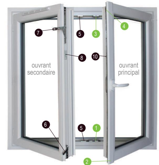
L'ouvrant principal est équipé de 2 points de fermeture sécurité : en bas (1 + 2) et en haut (3 + 4). Selon la largeur de la menuiserie, la décondamnation de l'ouvrant secondaire s'effectue soit par 2 verrous levier (5 + 6 et 7 + 8), soit par une gâche ressort en partie basse (5a).
