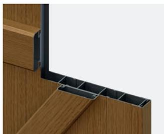
Un **profil listeau** est disponible **en option** (sauf sur gonds existants et sans feuillures de maçonnerie) sur tous nos modèles de volets alu extrudé. Il corrige les éventuels défauts d'aplomb du tableau et **permet d'augmenter l'occultation et l'isolation du volet.**
