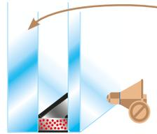
Des épaisseurs de vitrage augmentées permettent de mieux filtrer les ondes sonores, garantissant un meilleur confort acoustique.
