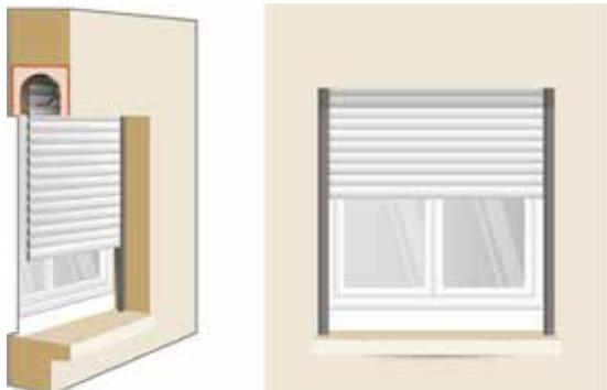
Pose en neuf dans un coffre tunnel
