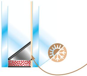
La chaleur est « capturée » à l'intérieur du logement grâce à une couche transparente de sels métalliques isolants faiblement émissive sur la face du double vitrage.
