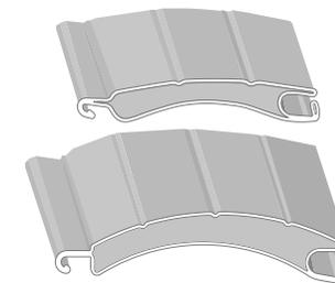
41 mm de largeur et de 8.5 mm d'épaisseur ou de 52 mm de largeur et de 13 mm d'épaisseur. Lame isolée et composée d'un feuillard aluminium, remplie de mousse isolante haute densité, elle est proposée en différents coloris.
